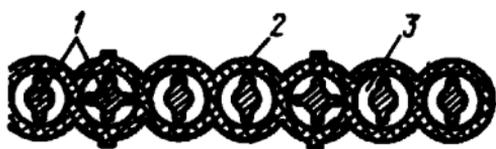
Рис. 7.5. Конструкция трубчатого (панцирного) электрода:
