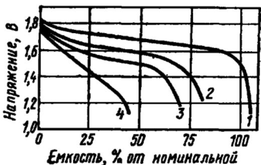
Рис. 11.2. Влияние температуры на разрядные характеристики НЦ аккумулятора при токе 0,5  $C_{ном}$  и температуре:
