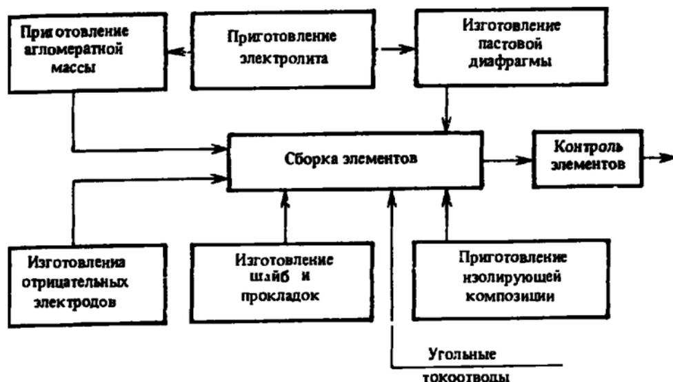
Схема 4.1. Краткая технологическая схема производства цилиндрических МЦ элементов
