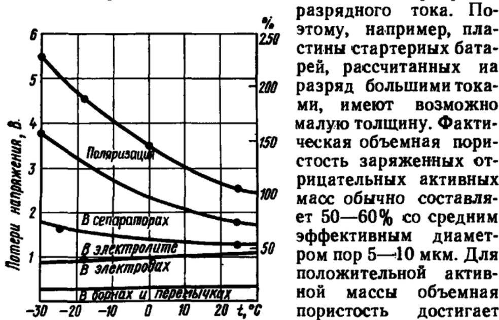
Рис. 7.10. Распределение составляющих баланса напряжения батарей 6СТ-132 в начале разряда током 396 А в зависимости от температуры
