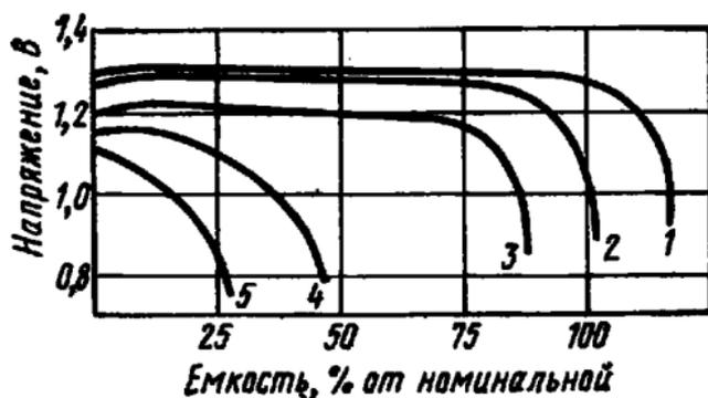
Рис. 4.9. Разрядные характеристики дискового элемента РЦ73 при температуре 50°C (1), 20°C (2) и 0°C (3—5):
