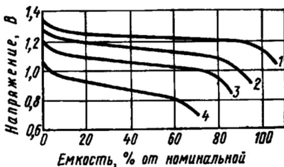
Рис. 9.2. Разрядные характеристики ламельного НК аккумулятора при температуре  $20^{\circ}\text{C}$  и разряде тока: 1 —  $0,1 C_{\text{ном}}$ ; 2 —  $0,5 C_{\text{ном}}$ ; 3 —  $1 C_{\text{ном}}$ ; 4 —  $2 C_{\text{ном}}$
