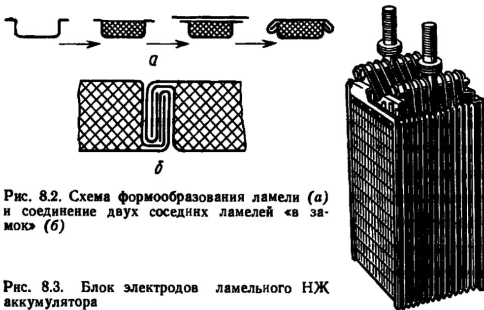
Рис. 8.2. Схема формообразования ламели (а) и соединение двух соседних ламелей «в замок» (б)
