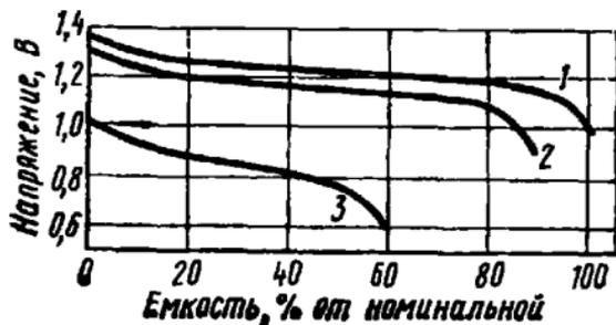
Рис. 3.3. Разрядные характеристики щелочного никель-кадмиевого аккумулятора:
