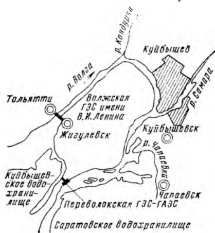
Рис. 3-3. Схематический план Переволокской ГЭС—ГАЭС (проект).
