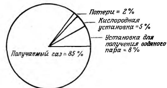
Рис. 3. Распределение тепловой энергии, содержащейся в твердых отходах.
